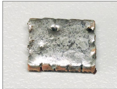
Pájka předem nanesená na výrobek a plošné ohřívání celého výrobku
