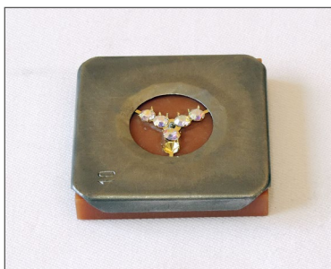
Fastovací přípravek pro ruční fastování šatonových kuliček
