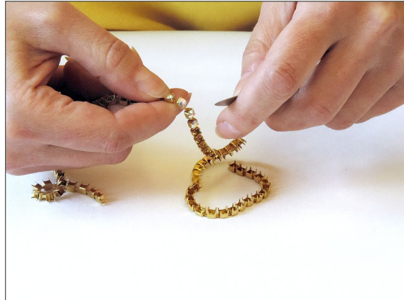
Ruční zavírání krapen kotlíku
