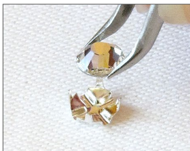
Vsazování kamene do kotlíku
